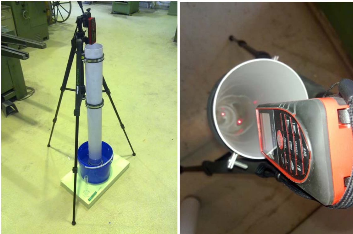
Abbildung 8: Prototyp für die Dichtheitsprüfung abflussloser Sammelgruben in Kleingärten
